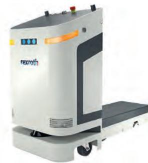
En la Hannover Messe, Bosch Rexroth presentó el ActiveShuttle, un vehículo autónomo que transporta los materiales desde el almacén hasta el área de la línea de producción donde se necesitan y realiza autónomamente la carga y descarga. Equipado con escáneres láser, busca su propia ruta, puede reconocer a otros vehículos y personas, y también puede aprender: crea su propio mapa del sitio y lo actualiza continuamente.
